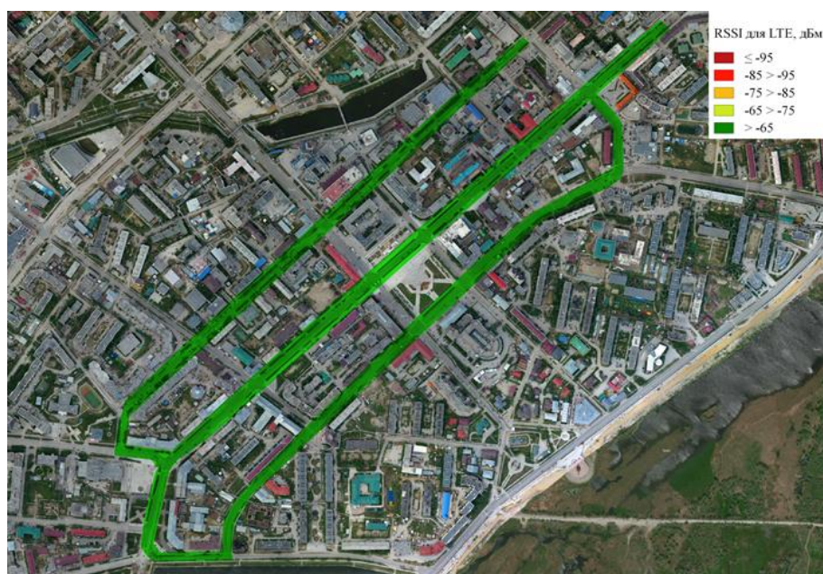
Рис. 4. Карта покрытия по параметру RSSI
