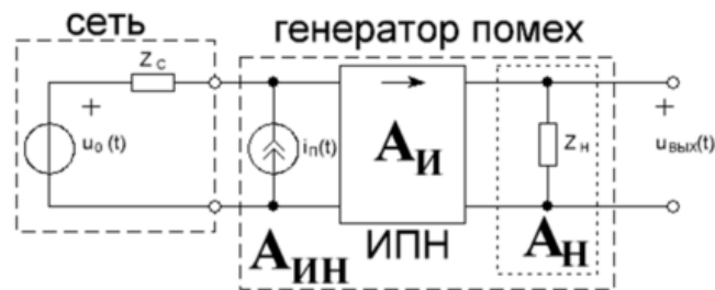
Рис. 1. Сеть и генератор помех без ФРП
