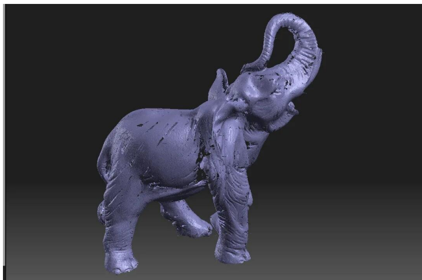
Рис. 2. Неполные участки на отсканированной модели
