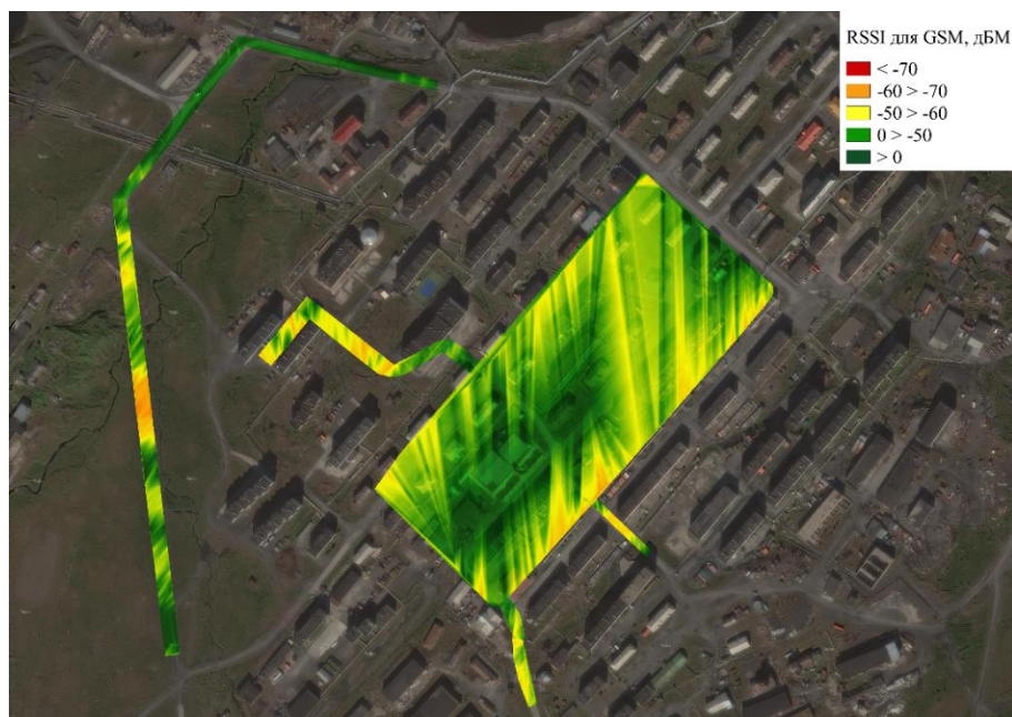
Рис. 2. Карта покрытия Тикси первым оператором
