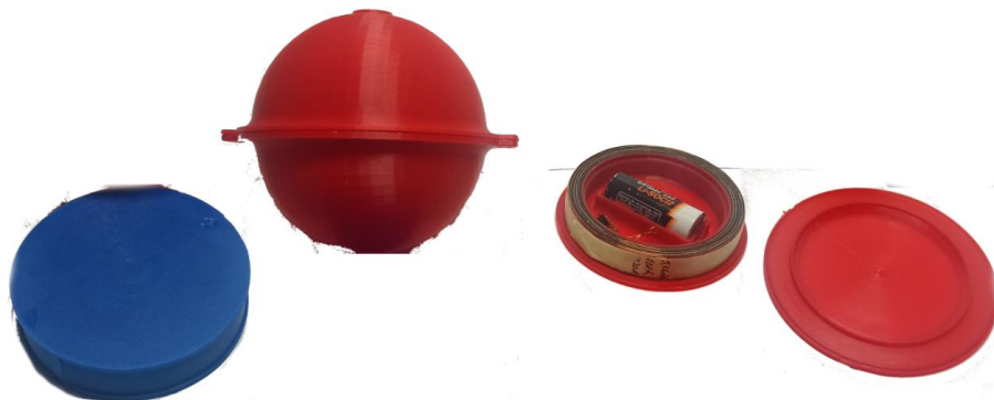
Рис. 6. Конструкция активного интеллектуального маркера
