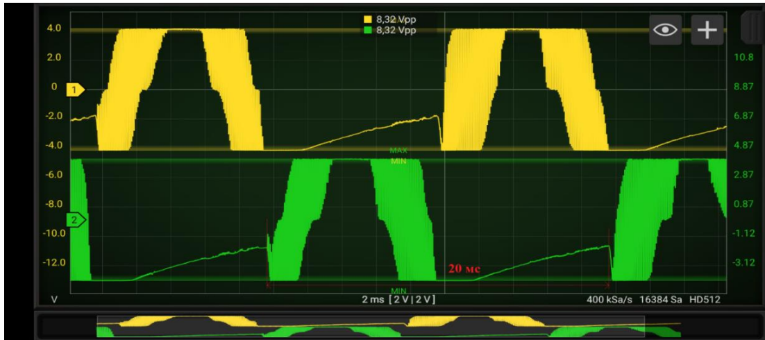
Рис. 4. Осциллограммы ШИМ сигналов управления 100 кГц транзисторами VT3 и VT4 мостовой резонансной схемы последовательного инвертора
