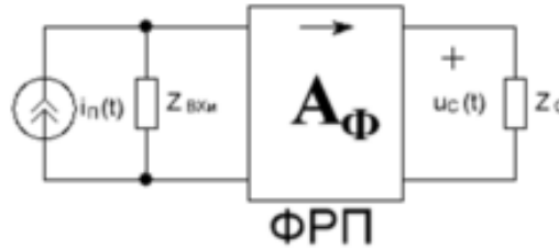
Рис. 4. Эквивалент сети и генератора помех с ФРП (определение уровня электромагнитных помех)
